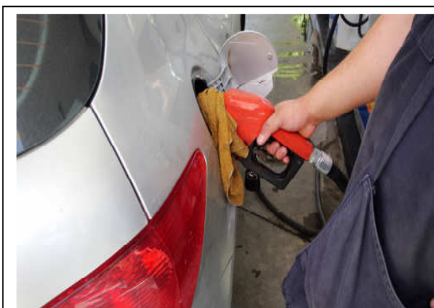
fig 3. O bico deve ser introduzido havendo um bom contato metal com metal, apoiado sobre um pano que impeça o contato do bico com o bocal do tanque.
