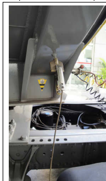
fig 3. Aterramento no Caminhão-Tanque
