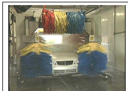
fig 5. O operador deve acompanhar o ciclo de lavagem sem desviar a atenção da máquina e do veículo.
