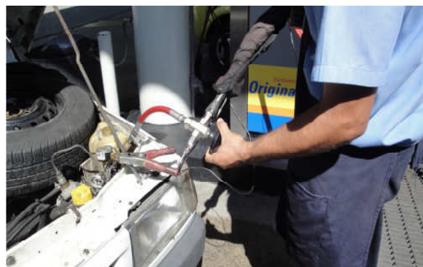
fig 2. Verificar O estado das garras do fio terra de todos os bicos de abastecimento existentes na ilha.
