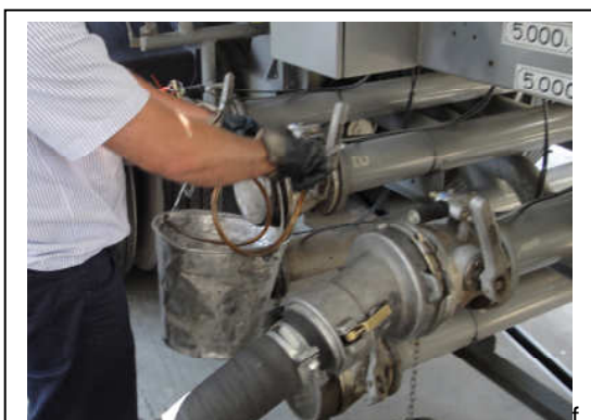
Fig 3.3. Ao descer do caminhão, o motorista deve abrir a válvula do compartimento descarregado e aguardar que todo o combustível esorra, utilizando-se de um balde de alumínio ligado com o cabo terra ao CT.
